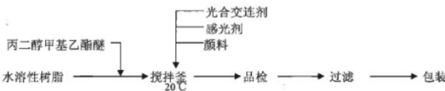
图6 电路板内层蚀刻（紫外光固化）油墨生产工艺流程图
