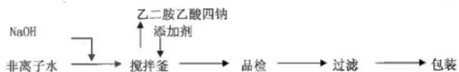
图3 沉铜液B生产工艺流程图
